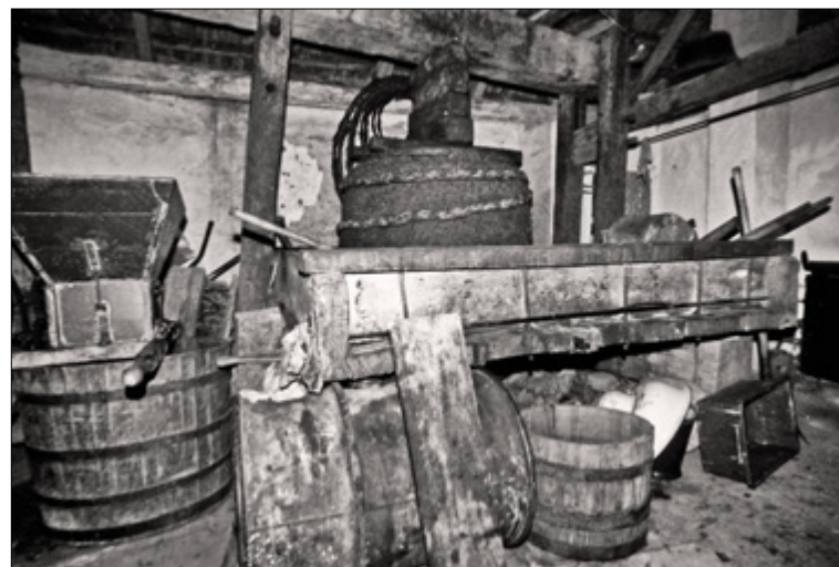
Szőlő préselése gúzsos préssel Jakab József pincéjében 1992-ben. A pince falazata tömés, eredetileg zsúptető fedte, de azt az 1960-as években cseréptetőre cserélték. A présházban meghagyták a régi gúzsos prést.
